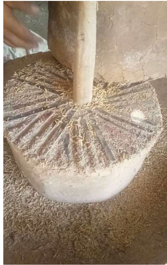
ภาพแสดงส่วนฐาน ของเครื่องสีข้าวกลองภูมิปัญญาพื้นบ้าน
